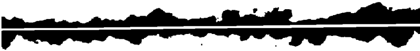
Abbildung 2 Die extrahierte Maske dient als Grundlage zur Ermittlung der Eindringtiefe Fotos und Grafiken: Nolax/FH Rosenheim
