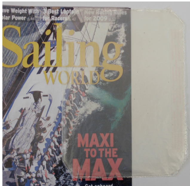
Abb. 3: flexible PlyEx Membran mit 4- Schichten (0/45/-45/90), Dicke: 20 µm.
