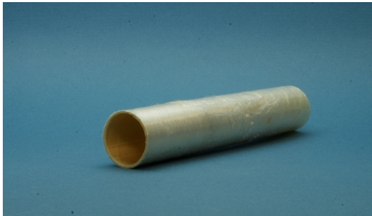
Abb. 1: Prototypenrohr, Durchmesser 25 mm, Wandstärke 0.1-1.5 mm, hergestellt ohne die Verwendung eines Klebstoffes.
