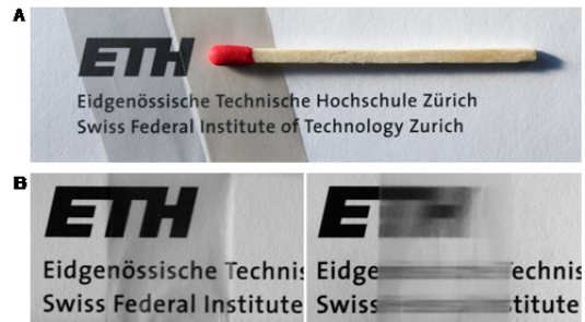
Abb. 2: A: links: PlyEx , rechts: PlyEx wärmebehandelt. B: links: PlyEx im direkten Kontakt mit dem Papier, rechts: PlyEx 15 mm über dem Papier.
