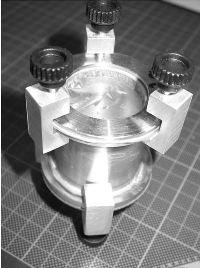
Bild 6: Einrichtung zur Prüfung der Wasserdampfdurchlässigkeit gemäss DIN EN 13726-2
