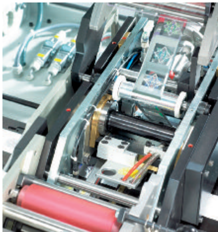
Eine Prägestation der Leonhard Kurz Stiftung zur Applikation von Sicherheitsmerkmalen auf Plastikkarten
